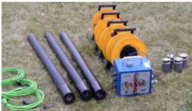
Figure 32 Système de réception (mobile) : 3 capteurs magnétique et 2 dipôles électriques permettent de mesurer les champs en surface
