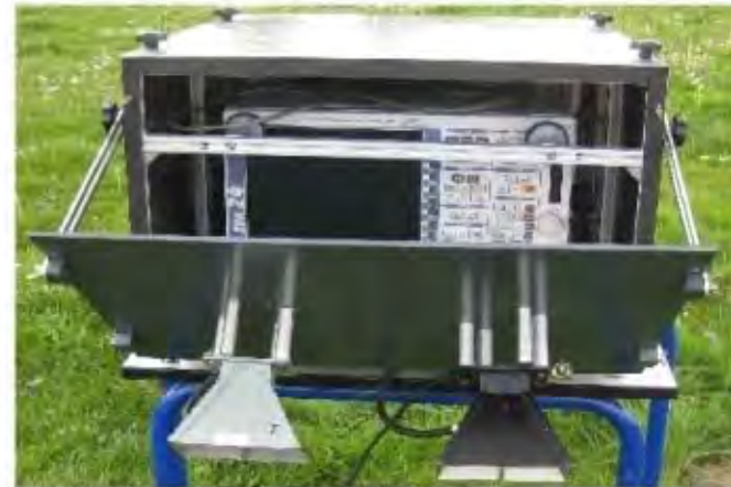
GB-SAR développé par l'IETR, expérimentations au CEN de Météo France, déc. 2010
