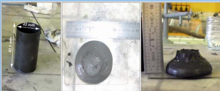
(1) Slump test au cylindre :
