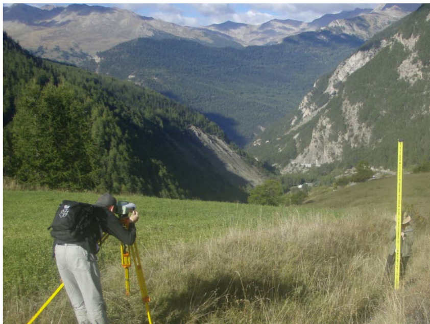
Mesure de nivellement à Saint-Ours, avec un niveau de précision et une mire Invar.
