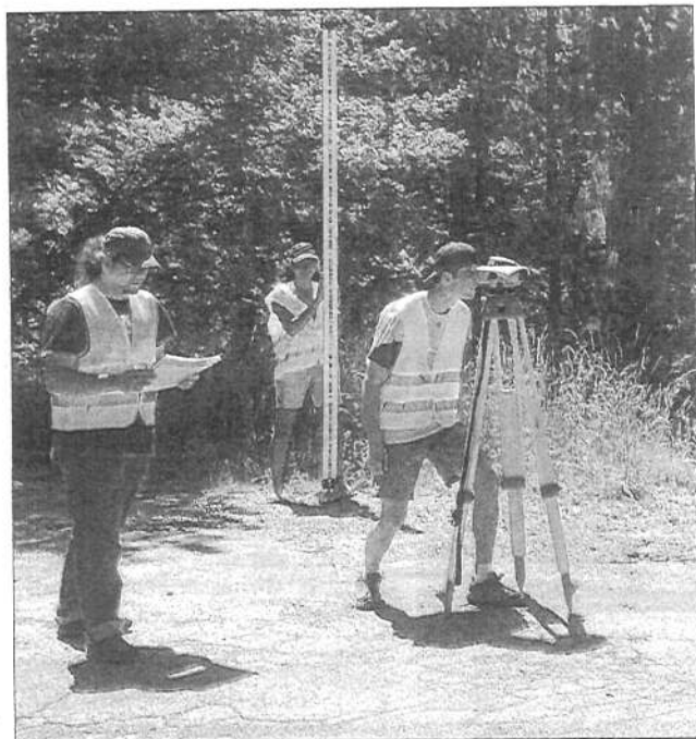
Nivellement du glissement de l'Adroit par une équipe de quatre étudiants de l'INSA de Strasbourg. Photo J.P.MALET/IPGS
